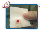
Ydersiden af kuvetten aftørresKontroller at kuvetten er fyldt korrekt
